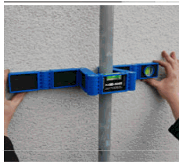
Die Biegsamkeit wird durch Metallglieder erreicht
